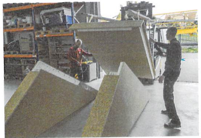
▲ Dort wurden die einzelnen, durchnummerierten Bausatz-Elemente zunächst in der richtigen Reihenfolge zusammengefügt
