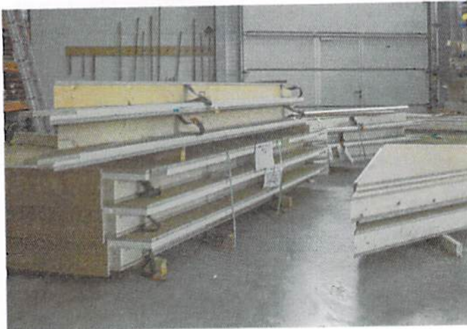
▲ Die PU-Sandwich-Elemente der Gauben wurden als Bausatz in die Werkstatt des Dachdeckerbetriebs geliefert
